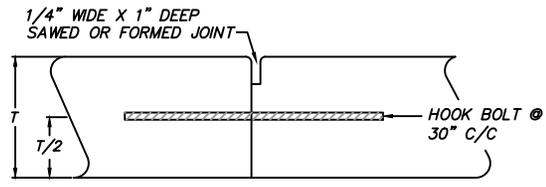
LONGITUDINAL JOINT FOR SINGLE LANE POURING
