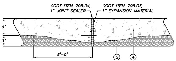
THICKENED CONCRETE EDGE EXPANSION JOINT
