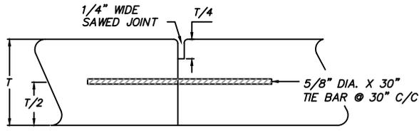
LONGITUDINAL JOINT FOR DOUBLE LANE POURING
